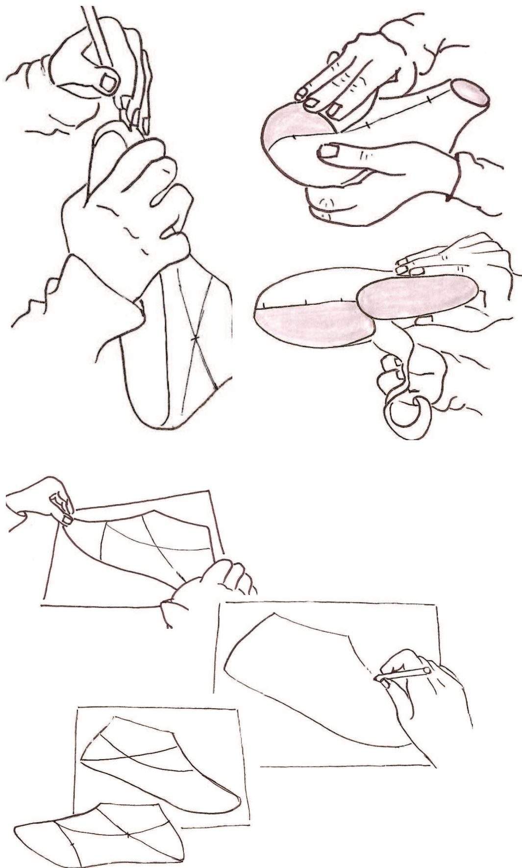
Fig. 75 - Seqüência de retirada e planificação do molde em fita crepe da forma
