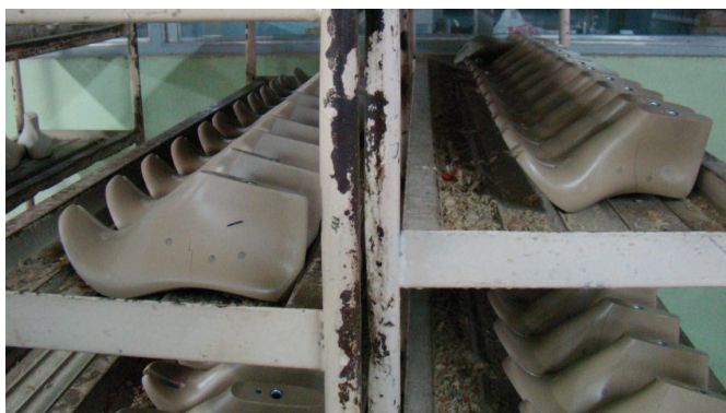
Fig. 60 - Série de formas iguais em PP de alta densidade
